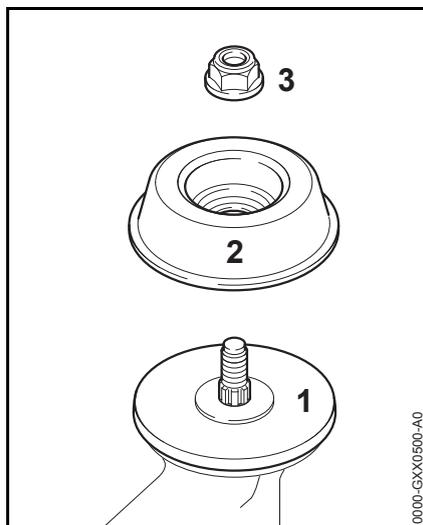
Dazu sind je nach Ausführung des Schneidwerkzeuges zusätzlich Mutter (3) und Laufeller (2) notwendig. Der Druckteller (1) muss bei allen Schneidwerkzeugen angebaut sein.
