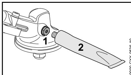
Getriebefett alle 25 Betriebsstunden prüfen und bei Bedarf schmieren:
