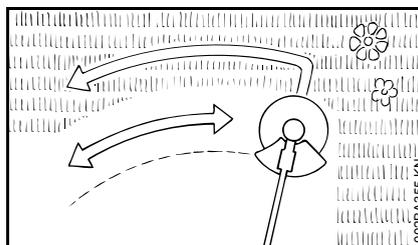
Beim Schneiden von Gras und Durchforsten junger Bestände das Gerät wie eine Sense dicht über dem Boden führen.
