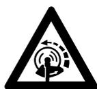
Motor nicht "aus der Hand" anwerfen – starten wie in der Gebrauchsanleitung beschrieben. Das Schneidwerkzeug läuft noch kurze Zeit weiter, wenn der Gashebel losgelassen wird – **Nachlaufeffekt!**
