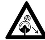
Beim Einsatz von Metall-Schneidwerkzeugen besteht die Gefahr des Rückschlags, wenn das Werkzeug auf ein festes Hindernis (Baumstamm, Ast, Baumstumpf, Stein oder dergleichen) trifft. Das Gerät wird dabei zurückgeschleudert – gegen die Drehrichtung des Werkzeuges.
